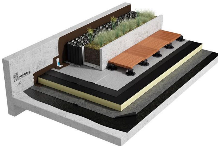
Exemple d'étanchéité multifonction sous dalles sur plots et bac végétalisé
